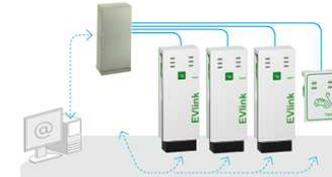
Überwachung, Steuerung und Auswertung der Ladeinfrastruktur, auch standortübergreifend
